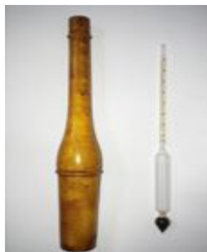
Anexo 10. Aerómetro para medir la densidad de las soluciones químicas.
